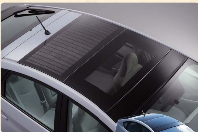
プリウス [ソーラーベンチレーションシステム] (一部グレードにオプション) トヨタ自動車株式会社
